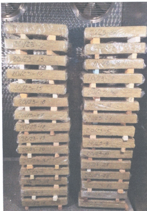
Рисунок 4 – Дослідні зразки, які піддають циклічному температурному впливу
